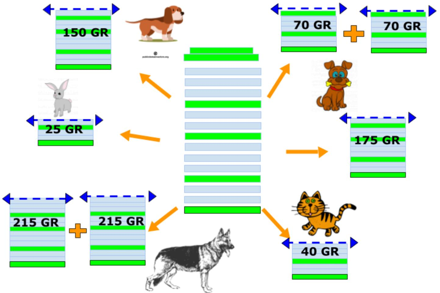
**doseat** est constitué d'étages identiques qui se clipsent et se déclipsent entre eux, d'un fond et d'un couvercle. Chaque étage contient un faible volume de croquettes ce qui permet de régler finement la dose sans peser.
